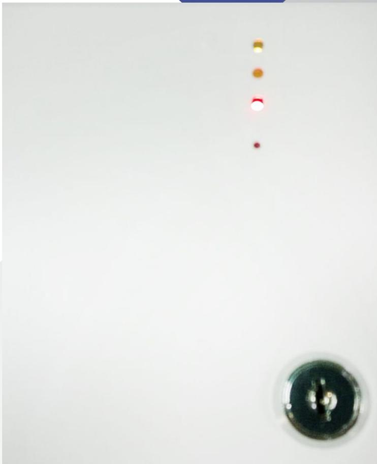
При нажатии на эту кнопку загорается красный светодиод. Это означает, что режим программирования включён.
