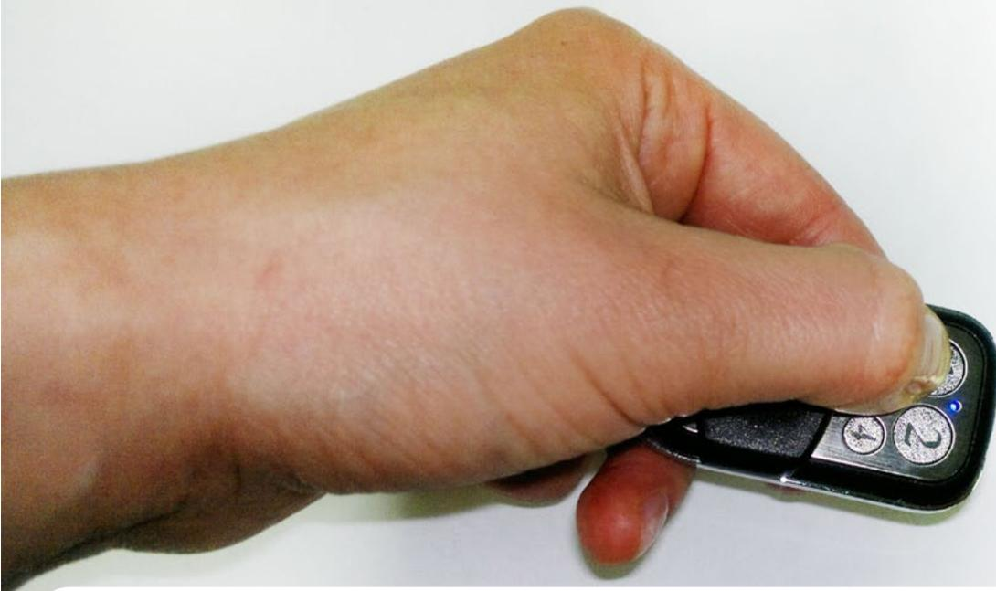
Чтобы начать процесс программирования, нажмите на одном из брелков кнопку № 1. Удерживайте эту кнопку нажатой в течение 3-5 секунд. В это время блок управления будет издавать короткие звуковые сигналы.
